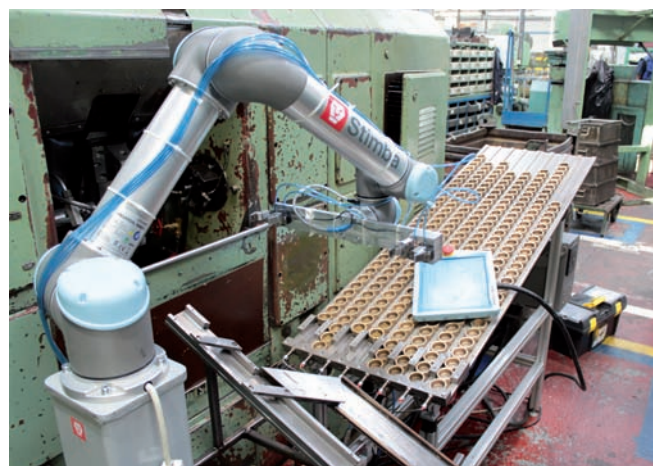
Zostava na opracovanie mosadzných výkovkov – robot UR5, zásobník výkovkov a stroj na opracovanie VAGON
