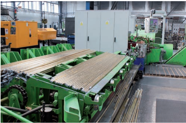
Kovacia linka AKL 35 – automatický zásobník tyčoviny na kovanie
