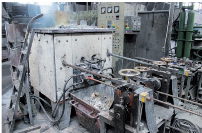
Indukčné pece na kontinuálne odlievanie mosadzných tyčí pre vlastné spracovanie technológiou kovania
